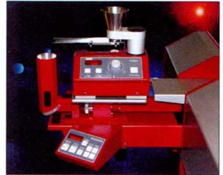
**Bild 3: RODOS/M mit VIBRI in Messposition des Sympatec HELOS.**
