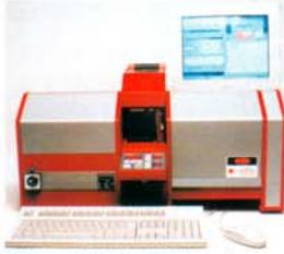
*Mit dem MYTOS & TWISTER wird eine gute Vergleichbarkeit zu Off-line Analysen gewährleistet. Erreicht wird dies durch die integrierte repräsentative Probennahme und die leistungsfähige Trockendispersion. Damit lässt sich erstmals eine in line gewonnene Partikelgrößenverteilung im Labor verifizieren und direkt als Produktspezifikation verwenden.*
