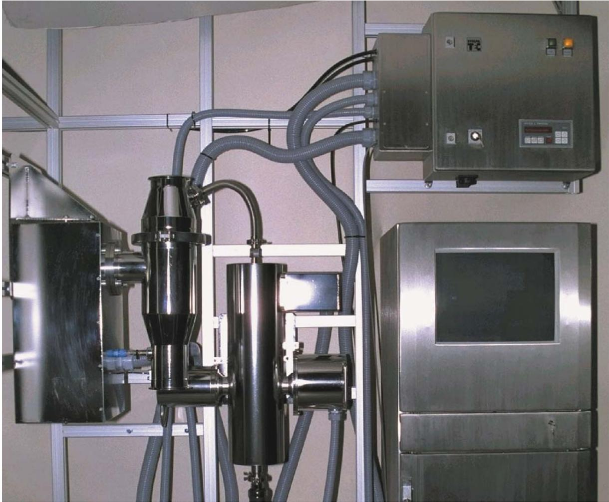
Abbildung 1: In-line System zur Partikelgrößenanalyse MYTOS & TWISTER in GMP-Ausführung
