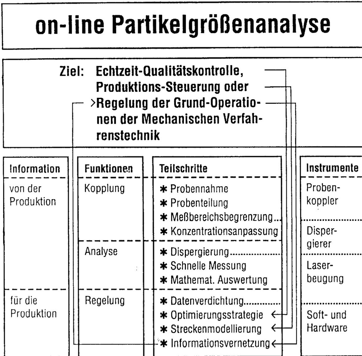
**Abb. 3: Funktionen, Teilschritte, Instrumente zur on-line-Partikelgrößenanalyse**
