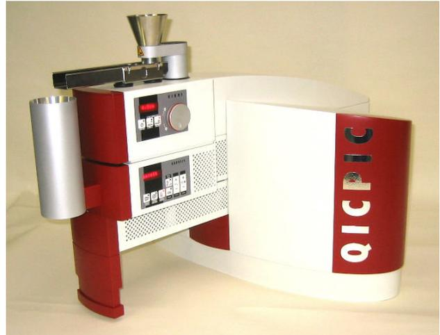
Abb. 4: Aufbau des DBA-Systems QICPIC™ mit Trockendispergiergerät RODOS/L™ und Dosiereinheit VIBRI/L™
