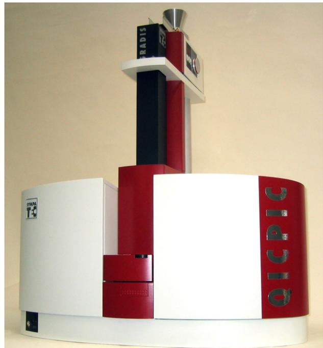
Abb. 5: Aufbau des DBA-Systems QICPIC™ mit Schwerkräftdispergierer GRADIS/L™ und Dosiereinheit VIBRI/L™
